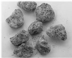
Knuste gruskorn fra pukkverk, rund
