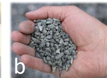
«8/11 mm Singel» også er en ensgradert grus med «kort fraksjon»
