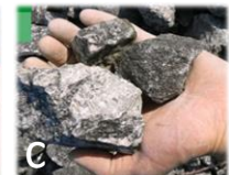
«20/120 mm pukk/kult» også er en middels gradert grusig stein
