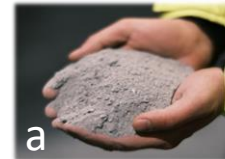
«Steinmel» også er en sand eller silt
